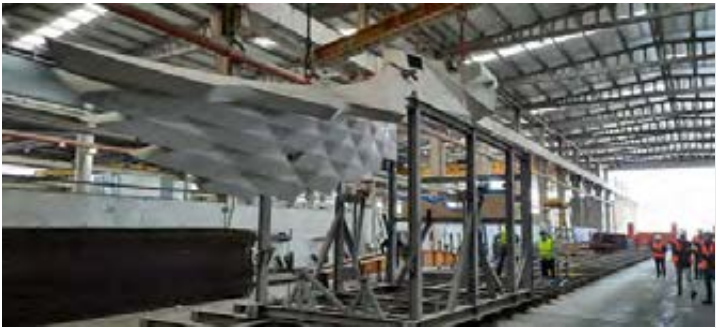
DESMOLDEO DE LAS ALAS DE LOS EVANGELISTAS CON HORMIGÓN BLANCO AUTOCOMPACTANTE. INSTALACIONES DE PRECON
