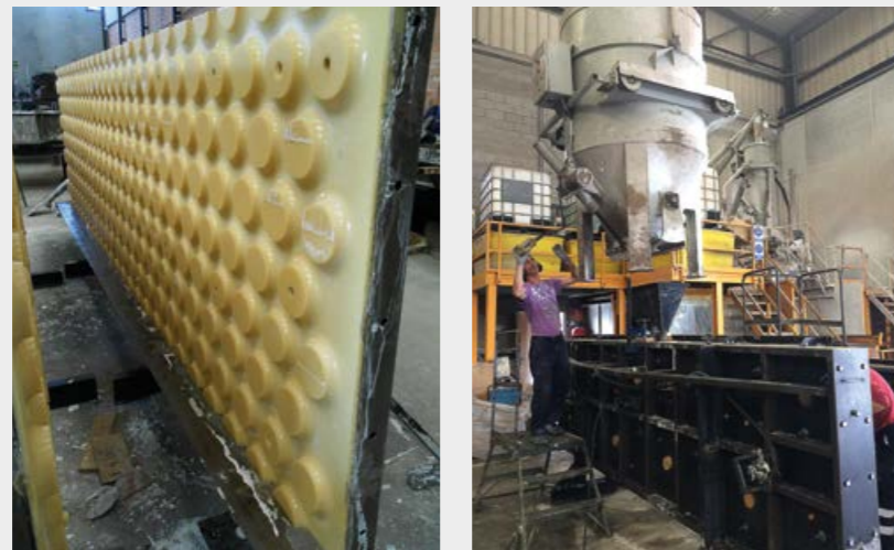
Fabrication du moule / Herstellung der Gussform
